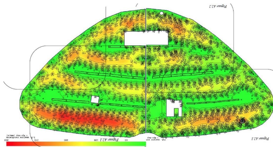
Figuur 6.6: Berekende veldmomenten in gehele vloer 4 [14] (rood geeft hoogste momenten weer)
