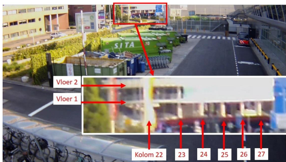
Figuur 4.4: Delen van het MPB die zichtbaar waren op CCTV Milieustraat [54]; een groot deel van vloer 2 is aan het zicht onttrokken vanwege aldaar gespannen bouwgaas
